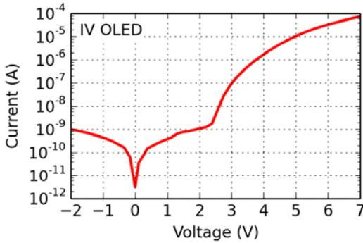
**I-V**特性曲线是OLED器件或者OPV器件最常见的量测技术. OLED器件除了I-V特性量测之外也会量测发光也即是 I-V-L曲线
