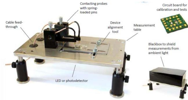
高集成度的硬件设计，测量台以及探测探针可以灵活控制便于用户测量不同大小的样品以及不同电极设计的样品
