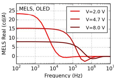
同**IS**量测技术类似给器件施加的直流偏置电压上叠加一个小信号交流电压信号，但是量测的信号是不同频率下EL信号的相位和振幅。**MELS**用来研究**OLED**器件内电荷的传输情况
