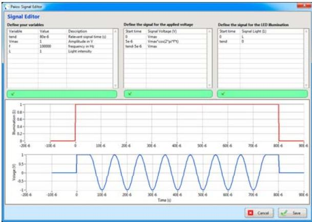
除了常用的测试信号用户可以通过公式自己制定任意波形测试电压，光强信号。用户可以对量测结果进行log, ln, exp, sin, x<sup>2</sup>, 1/x, 1/x<sup>2</sup>, √x, 1/√x, 1-x, 1-x<sup>2</sup>各种数学关系式绘图
