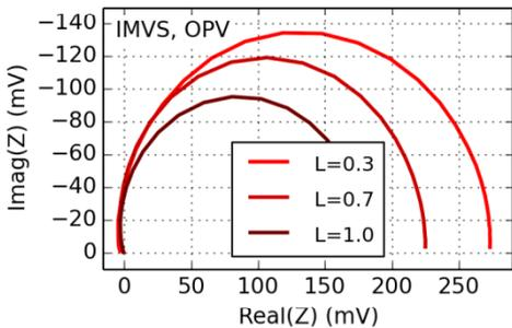
**IMVS**量测技术与IMPS技术类似，不同点在于电池片处于开路状态，主要用来提取电池片内部电荷的寿命。
