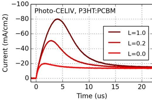
**CELIV**技术是比较有名的提取载子移动率，复合系数，掺杂浓度等参数的技术。**CELIV**在有机太阳能电池量测上很有名气，但是它也可以量测钙钛矿电池以及**OLED**器件。给器件施加反向的斜率上升电压，可以提取器件内的载子，获取的电流-时间曲线的峰值位置与载流子移动率有关，用来计算载流子移动率
