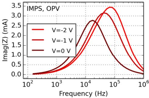
**IMPS**用来研究有机太阳能电池内电荷的传输，太阳能电池处于短路状态时被恒定光强度光信号照射，恒定强度光信号照射时同时叠加一个小的调变光信号，量测不同频率下短路电流的振幅跟相位
