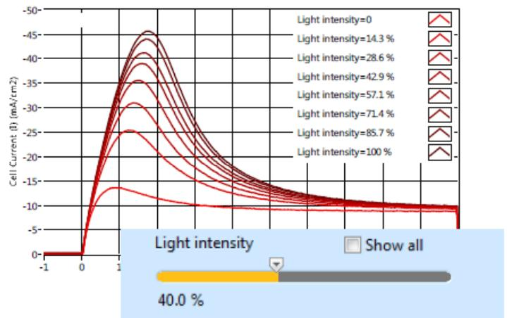
Paios可以进行参数扫描量测，一次性量测得到不同参数下的量测结果；
