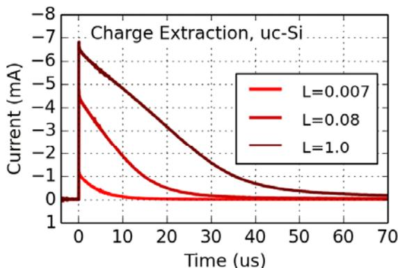
**CE**量测技术主要用于量测有机太阳能电池，量测时电池先处于开路状态并进行光脉冲照射，当光脉冲关闭时同时将电池片切换至短路状态进行提取电荷，此技术用来获取器件内的电荷载子浓度
