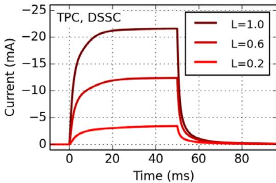
**TPC**量测技术量测瞬态光电流，主要用于量测有机太阳能电池. 通过TPC上升曲线和下降曲线可以得到载流子移动率Mobility，以及研究器件的trapping动态等.
