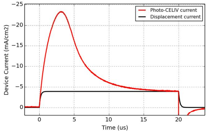
由于薄膜器件普遍存在RC效应，对于新型瞬态量测技术一般产生明显的干扰，Paios具备提取Rs串阻，Cgeo几何电容程序，进一步计算位移电流经过RC效应的修正而获得正确的电流。
