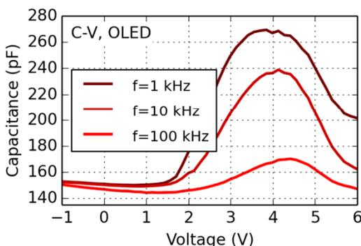
**CV**量测技术是量测器件的阻抗时让频率固定，直流偏置电压做扫描进而得到器件的C-V曲线。C-V曲线可以得到器件的内建电场，以及注入能障等信息。
