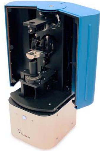
**Phelos**是针对OLED器件的发光特性量测而设计的，它可以量测再不同角度不同偏振下的器件的EL和有机材料PL光谱，再通过计算或者与Setfos模拟软件搭配获得OLED器件或者有机材料的其他参数，例如：IVL, EQE, lm/W, Cd/A, CIE<sub>x,y</sub>, 以及发光层材料dipole方向性，dipole分布情况，pl等。
