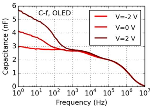
**IS**量测技术是一种广泛应用的量测技术，既可以量测OPV也可以量测OLED研究这些器件的电荷动态特性。给器件施加的直流偏置电压上叠加一个小信号交流电压信号，量测不同频率下电流信号的相位跟振幅进而得到器件的复阻抗谱。
