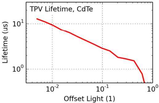
与TPC量测技术类似，也是量测器件在光脉冲下的相应，主要用于量测有机太阳能电池. 次量测技术中有机太阳能电池处于开路状态。通过TPV下降曲线可以得到载流子lifetime
