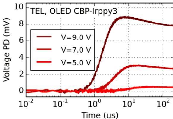
**TEL**量测技术主要用来量测**OLED**器件并获取载流子移动率以及磷光寿命等，量测时也是给器件加一个短脉冲电压量测瞬态EL信号，通过EL信号时间跟施加电压信号时间之间的**delay time**可以计算出载子移动率。分析EL信号的衰减曲线可以得到磷光寿命
