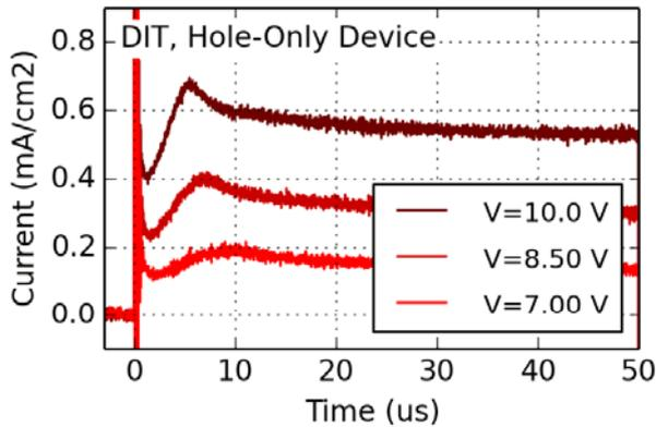
**DIT**量测技术主要用于量测单载子器件并获取载子的移动率，量测时给器件加一个短的电脉冲量测器件的瞬态响应电流，通过响应电流峰值位置的时间来计算得到载子移动率
